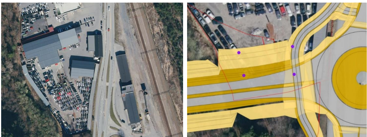
Figur 2-6: Til venstre: Bilde av eiendommen merket i grunnforurensningsdatabasen i 2019. Til høyre: Bilde som viser ca. hvilke deler av eiendommene som berøres av prosjektert vei. For endelig avgrensning vises det til plangrensen. Punkter i kartet viser hvor det er prøvetatt for forurensning i jord. [11].
