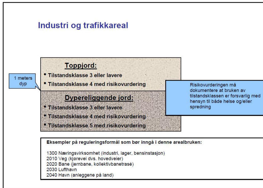
Figur 4-1: Figur hentet fra veileder TA-2553, figuren viser hvilke tilstandsklasser som er akseptable på et areal regulert til industri eller trafikk. Det skilles på toppjord (0-1 m) og dypereleggende jord.
