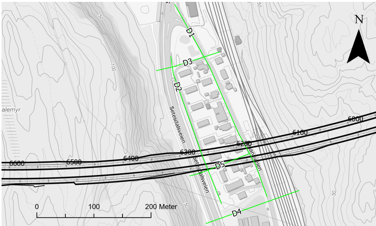
Figur 2-11: Oversikt over utført refraksjonsseismikk ved Dalane.
