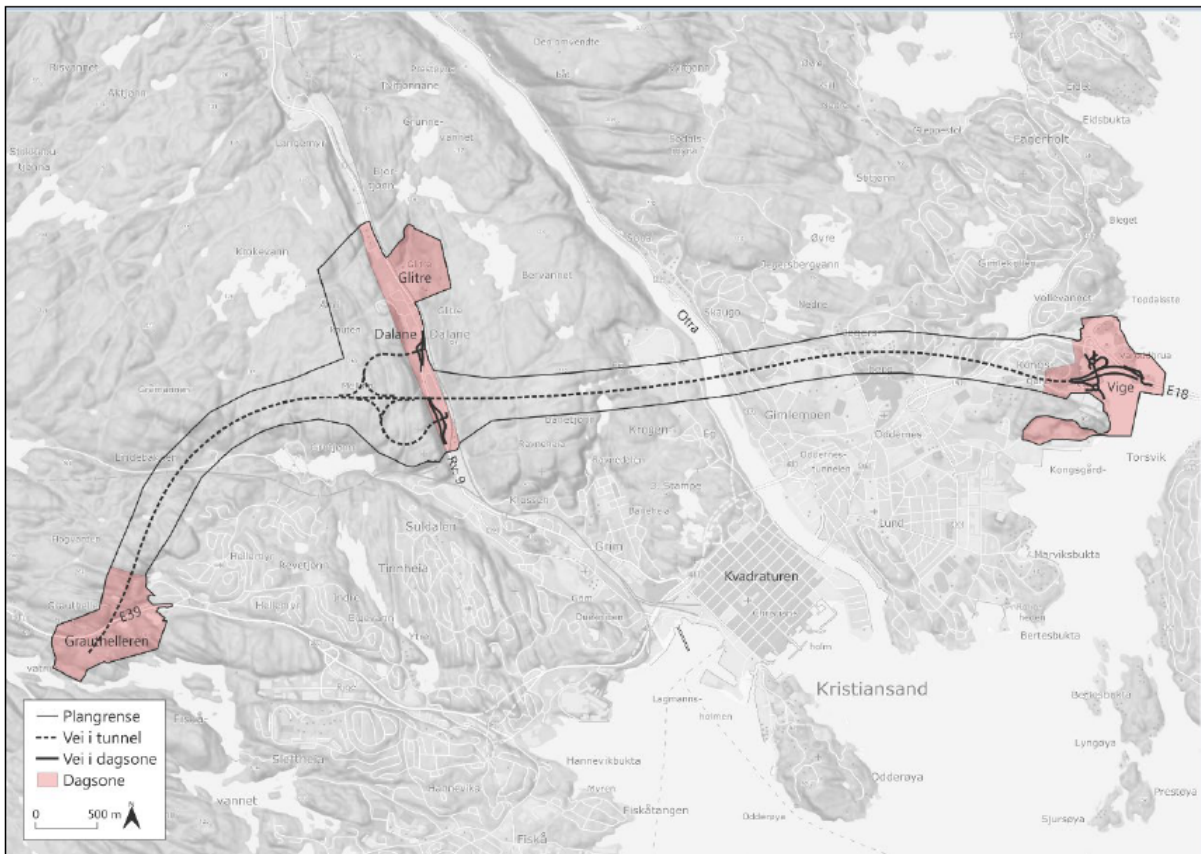
Varslingsgrense (sort yttergrense) for reguleringsarbeidet. Sort stiptet linje viser veitrasé i tunnel. Områder markert med rødt viser der tiltaket vil berøre på eller over bakken.
