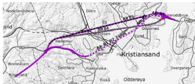
Figur 1-4: Figuren viser et eksempel på alternative trasévalg som ble vurdert i verdianalysen: Tunnel under Otra uten kryss på rv. 9.
