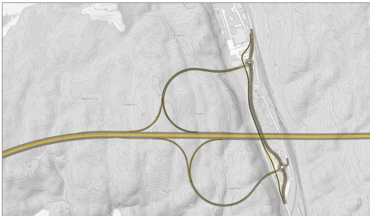
Figur 5-3: Kryssløsning DS, sør i Dalane. Fra to nye rundkjøringer på rv. 9 leder tilførselstunneler til kryss i berg. Mellom rundkjøringene må rv. 9 oppgraderes til 4-felt. Kryssløsningen er å betrakte som en videreutvikling av foreslått kryssløsning i verdianalysen.
